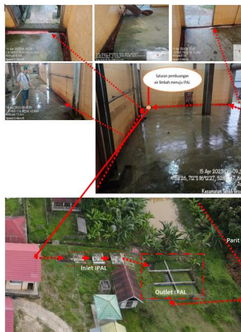
Gambar 3 Alur Aliran Air Limbah RPH menuju IPAL
