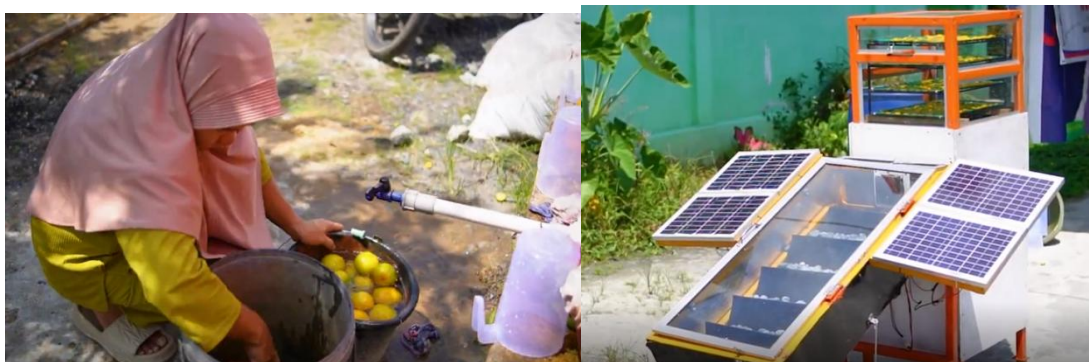
Gambar 2. Proses Pengeringan kulit jeruk siam dengan alat pengering
